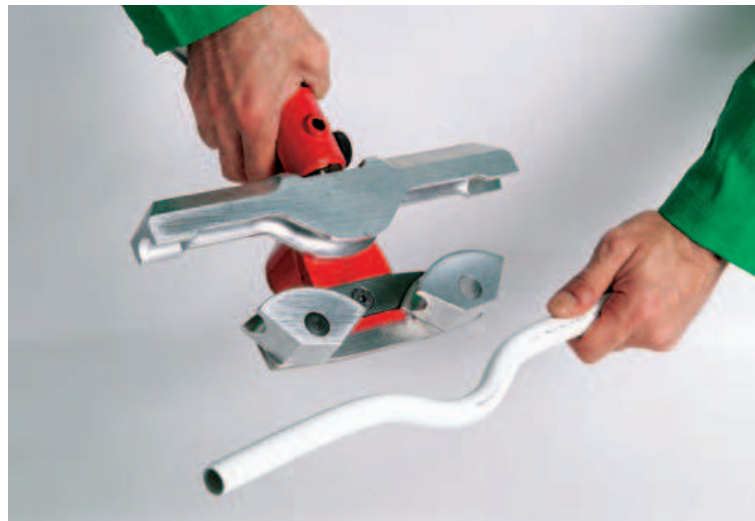
Biegemaschine CPS 26 für Überspringbogen (für Ø 20-26 mm)
